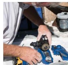
3. Setzen Sie die neue Pumpe in das Spritzgerät.
