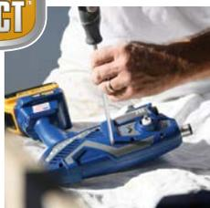
1. Entfernen Sie die Abdeckung mit einem Schraubendreher.
