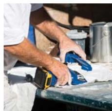
2. Nehmen Sie die alte Pumpe aus dem Spritzgerät.
