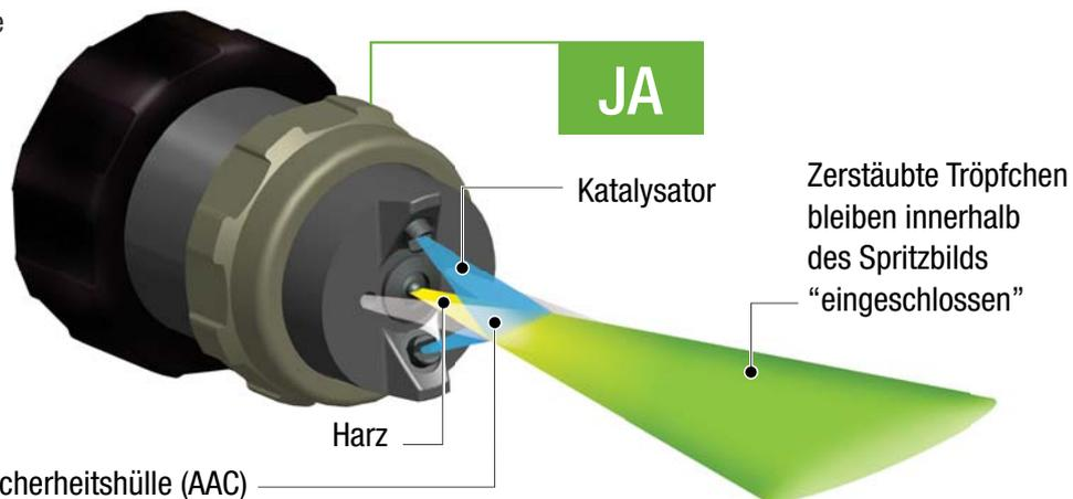
Die luftunterstützte Sicherheitshülle (AAC) von Graco:
