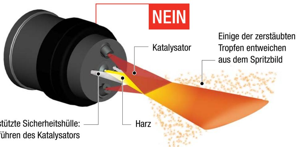
Herkömmliche luftunterstützte Sicherheitshülle: **VOR DEM** Einführen des Katalysators
